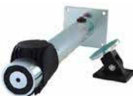
Retenedor de pared de 400N, con soporte abatible a 90° (300 mm) para suelo o 180° (325 mm) para pared. Cabeza giratoria de plástico reforzado con fibra de vidrio y pulsador de desbloqueo rojo. El equipo libera la puerta cuando se deja de aplicar la tensión de 24Vcc. Incluye diodo de protección y polarización y placa ferromagnética articulada Ref. 960110.
